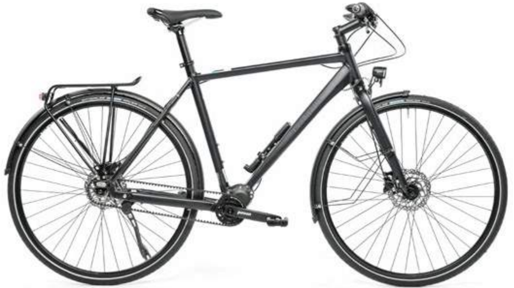
Wartungsarm, guter Schwerpunkt: Pinion 6-Gang-Getriebe.
