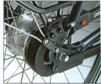
Klasse Kombi: 9-Gang-Nabengetriebe und „schwimmender“ Kettenschutz
