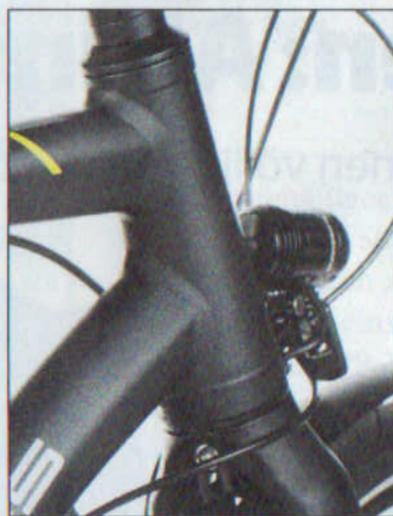
Sorgfältiges Smooth Welding macht das Hercules hübsch und stabilisiert die Rohrknotten.
